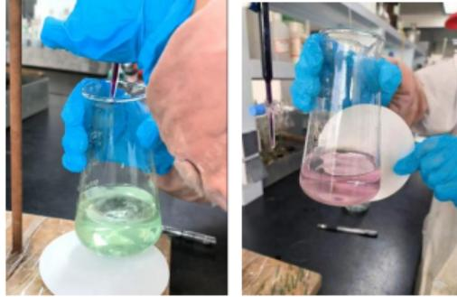
图 2：依据测定方法进行铜含量测定，滴定终点前后照片。（图左）滴定终点前；（图右）滴定终点后。
