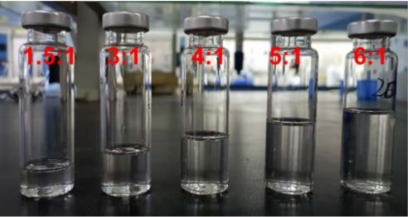
图 5 硅油(330000 mm 2 /s)不同比例溶剂溶解结果对比
